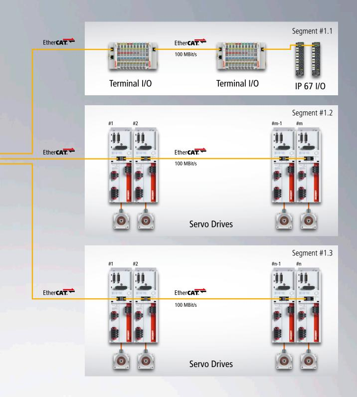
Als EtherCAT-G-Master können alle Beckhoff Industrie-PCs mit einem Standard-GBit/s-Port genutzt werden. TwinCAT übernimmt die Ansteuerung des Port; für den Anwender ändert sich nichts. Über den 3-Port-Branch-Controller CU1403 können EtherCAT- und EtherCAT-G-Netzwerke kombiniert werden. Der Abzweig kann dabei sowohl mit 100 MBit/s als auch mit 1 GBit/s betrieben werden, je nach angeschlossenen Teilnehmern.
