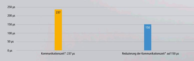
$<sup>\</sup>hbox{$^*$ Kommunikationszeit} = \hbox{Senden} + \hbox{$D$urchlaufverz\"{o}gerung} + \hbox{Empfangen}$
