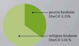
350 MBit/s genutzte Bandbreite 650 MBit/s verfügbare Bandbreite
