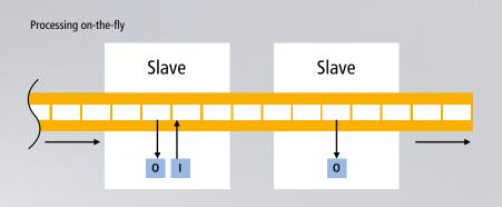
EtherCAT G ist die Fortführung des EtherCAT-Erfolgsprinzips in nun technologisch verfügbaren Geschwindigkeiten mit 1 GBit/s und 10 GBit/s. Das EtherCAT-Protokoll selbst bleibt dabei unverändert. Das vom EtherCAT-Master ausgesandte Telegramm durchläuft alle Teilnehmer. Jeder EtherCAT-Slave liest die an ihn adressierten Ausgangsdaten "on the fly" und legt seine Eingangsdaten in den weitergeleiteten Frame jetzt mit 1 bzw. 10 GBit/s. Das Telegramm wird nur
