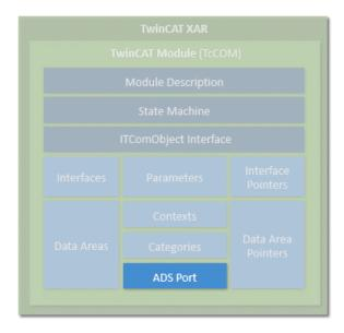
Jedes Modul, das beim ObjectServer eingetragen ist, kann per ADS erreicht werden. Der ObjectServer nutzt dabei die ITComObject Schnittstelle der Module, um z.B. Parameter zu lesen oder zu schreiben oder auch um auf die Zustandsmaschine zuzugreifen. Es gibt zusätzlich die Möglichkeit der Implementierung eines eigenes ADS Ports, über den eigene ADS Kommandos empfangen werden können.
