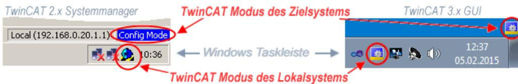
Abb. 65: Unterscheidung Lokalsystem/ Zielsystem (links: TwinCAT 2; rechts: TwinCAT 3)
