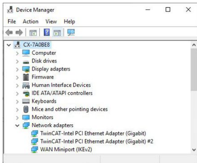
図 28: Windows 10のデバイスマネージャにおけるイーサネットインターフェース (X000、X001) の表示。
